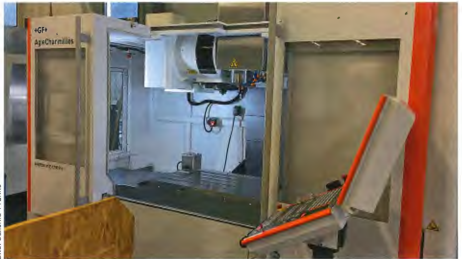
Mikron-Bearbeitungszentrum bei Saxonia-Franke AG: Während einer Testphase von rund drei Monaten wurde B-Cool 755 auf der 3-Achsen-Fräsmaschine Mikron VCE 1000 Pro getestet.
