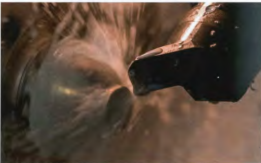
Kühlschmierstoff in Aktion bei einer Drehoperation bei Helfenstein Mechanik: verbesserte Oberflächenqualität und verlängerte Standzeit des Kühlschmierstoffes.
