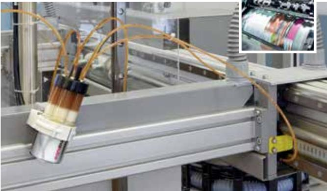
Ein simalube multipoint schmiert 5 Linearführungen einer Schneid- und Papierstapelmaschine in einer Druckerei.
