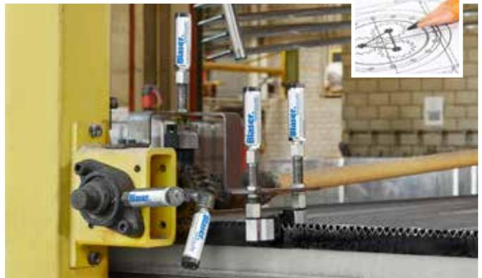
Blaso-Pro Spender 15 ml mit Bürste versorgen die Zahnstange eines Beschickungsautomaten stetig mit Öl. Weitere Blaso-Pro Spender 15 ml schmiern das Flanschlager mit Fett.
