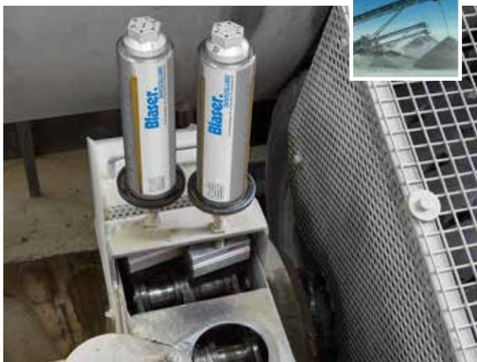
Zwei Blaso-Pro Spender 250 ml mit Bürsten schmieren und reinigen den Kettenantrieb einer Trommelwaschmaschine.
