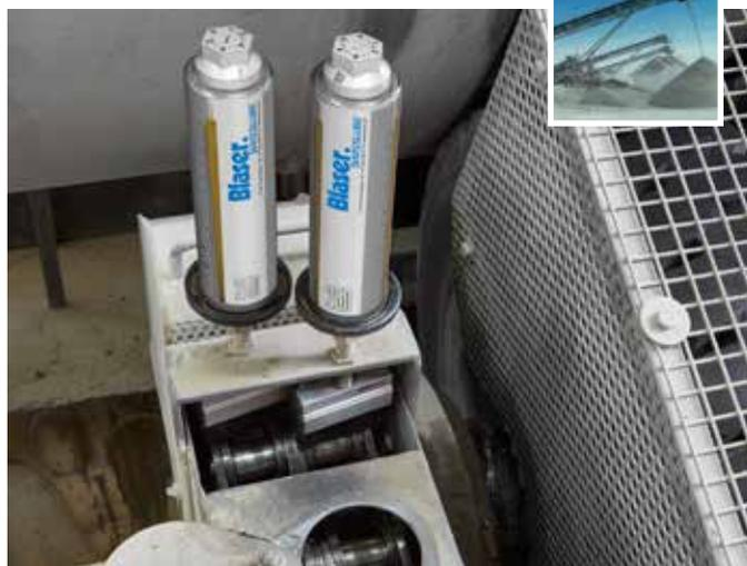
Due lubrificatori Blaso-Pro da 250 ml dotati di spazzole lubrificano e puliscono la catena di trasmissione di una macchina di lavaggio a tamburo.
