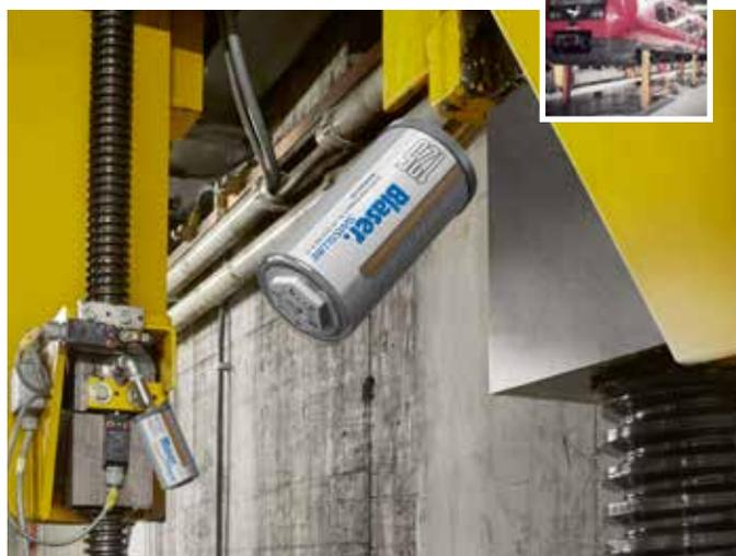
I mandrini di una stazione di sollevamento per vagoni ferroviari e locomotive sono lubrificati con Blaso-Pro 125 ml per un periodo di 12 mesi.
