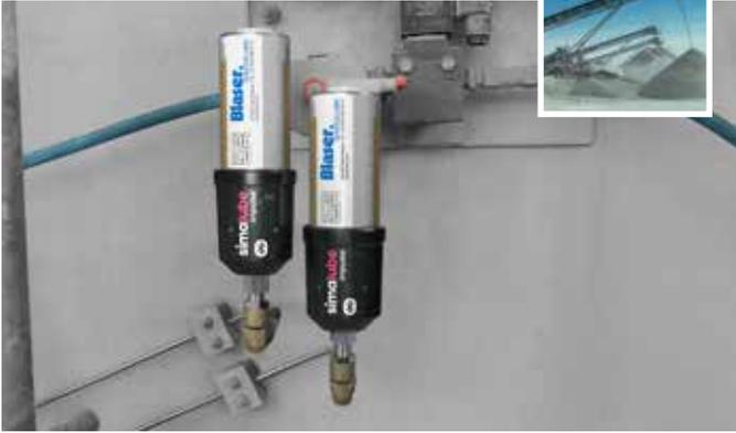
In una cava di sabbia si impiega il simalube IMPULSE connect con lubrificatore Blaso-Pro da 125ml. I dispositivi sono configurati e monitorati tramite l'app «simatec world of maintenance».
