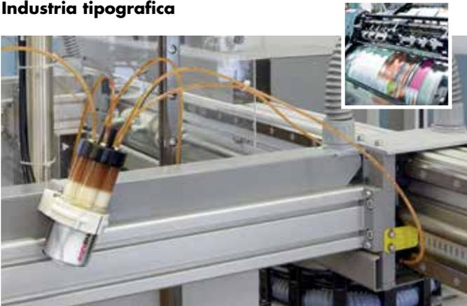
Un lubrificatore simalube multipoint lubrifica 5 guide lineari di una macchina di taglio e impilamento della carta in una stamperia.
