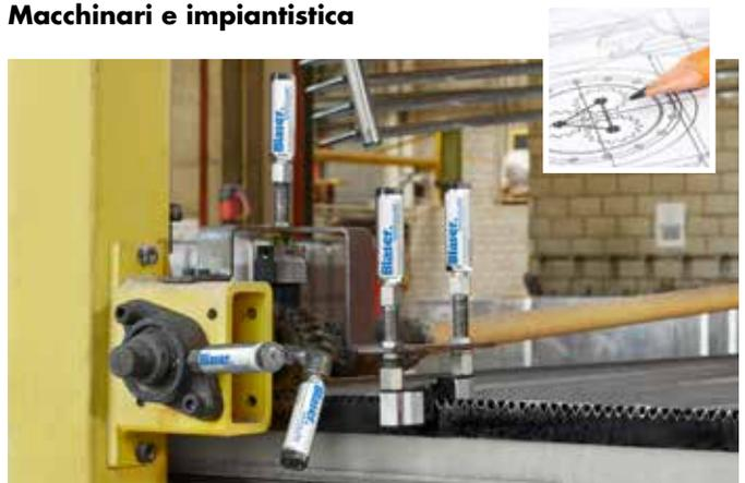
I lubrificatori Blaso-Pro da 15 ml dotati di spazzole erogano costantemente olio per lubrificare la cremagliera di una linea di carico. Altri lubrificatori Blaso-Pro da 15 ml lubrificano con grasso i cuscinetti flangiati.
