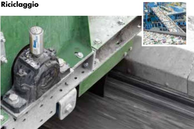
Un lubrificatore Blaso-Pro da 125 ml lubrifica il cuscinetto alla base di un nastro trasportatore.
