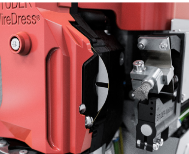
配备 Studer WireDress 的磨床
