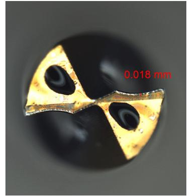
3421孔后刀具磨损<20µm
