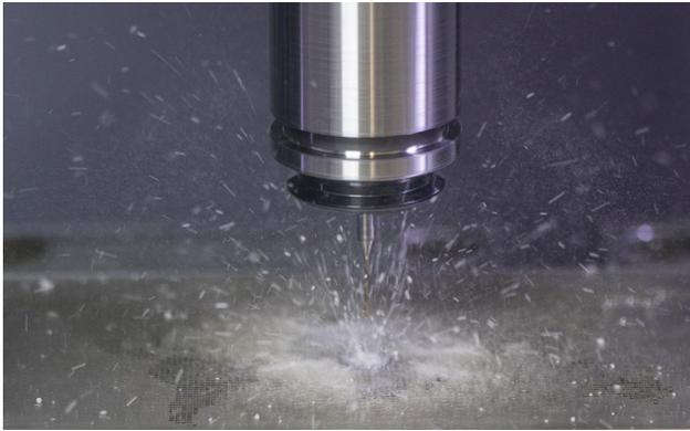
较低的粘度，可确保在高流体压力下，实现最佳冷却和润滑性能
