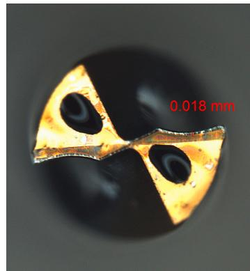
3421孔后刀具磨损<20μm
