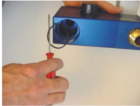
4. O-Ringe (30 und ev. 25) ersetzen
