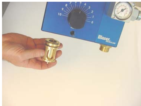
6. Düse (26+28) und Distanzhülse (27) zusammen einbauen
