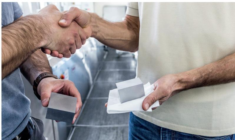
Superfícies impecáveis: líquido de refrigeração convencional (à esquerda) x Synergy 735 (à direita)
